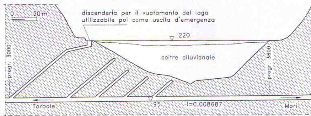
Fig. 8.78: schema dell'intervento realizzato per il drenaggio del lago di Loppio.
